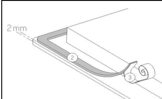
Die Dichtung (2) nach Abnehmen der Schutzfolie (3) mit 2 mm Abstand von der Außenkante des Glases aufkleben.
